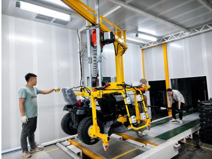
非标夹具与整机、气路、操作扶手同步设计
